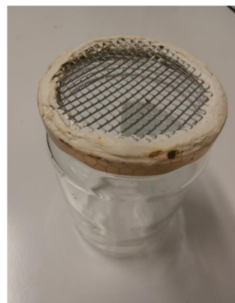
Photo 2 : « shaker » fabriqué à partir d'un pot de 1 kg et d'une grille de maille 3 mm pour le lavage au sucre glace
