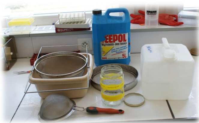
Photo 5 : matériel nécessaire pour le lavage au laboratoire (solution à base de Teepol®).
